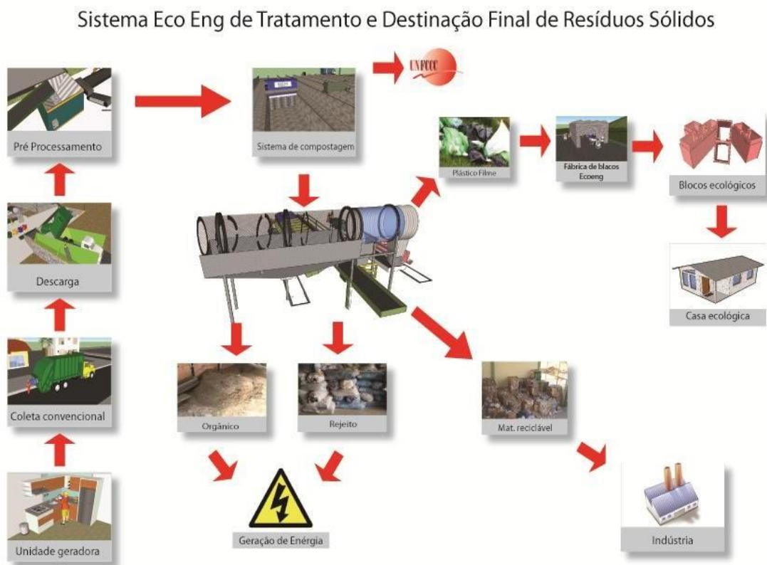
Figura 12: Sistema Eco Eng - Tratamento e destinação Final de Resíduos Sólidos
