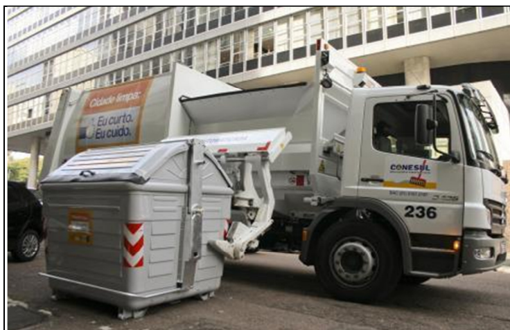
Figura 03 - Coleta containerizada em Porto Alegre
